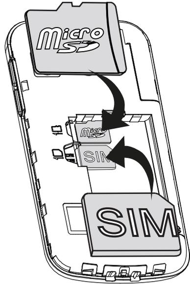
Fare attenzione a non graffiare o piegare i contatti presenti sulla scheda SIM. In caso di bisogno e di problemi con la rimozione/sostituzione della scheda SIM, utilizzare del nastro adesivo sulla parte esposta della scheda SIM per estrarla.
