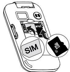
3. Optional: Suchen Sie die SD-Karten-Halterung und schieben Sie die SIM-Karte vorsichtig in die Halterung. Das Gerät kann mit oder ohne installierter SD-Karte verwendet werden. Kompatible Kartentypen: microSD, microSDHC.
