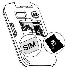
3. Optional: Suchen Sie die SD-Karten-Halterung und schieben Sie die SIM-Karte vorsichtig in die Halterung. Das Gerät kann mit oder ohne installierter SD-Karte verwendet werden. Kompatible Kartentypen: microSD, microSDHC.
