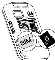
3. Facoltativo: Individuare l'alloggiamento della scheda SD, quindi farla scorrere delicatamente nell'alloggiamento. Il dispositivo funziona con o senza una scheda SD inserita. Tipi di schede compatibili: micro SD, micro SDHC.
