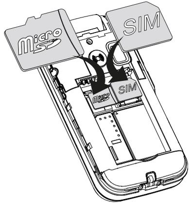
Die Kontakte der SIM-Karte dürfen nicht zerkratzt oder verbogen werden. Wenn Sie die SIM-Karte entfernen/austauschen müssen und Probleme beim Entfernen/Einlegen haben, kleben Sie ein Stück Klebeband auf den freiliegenden Teil der Karte und ziehen Sie sie damit heraus.
