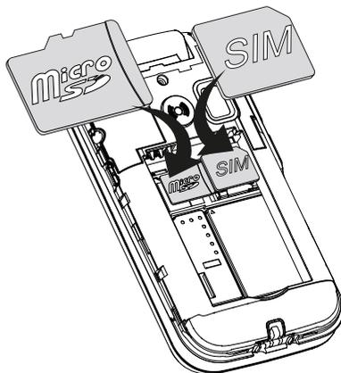
Tenga cuidado de no rayar ni doblar los contactos de la tarjeta SIM. Si tiene dificultades a la hora de retirar/sustituir la tarjeta SIM, utilice cinta adhesiva en la parte expuesta de la tarjeta SIM para extraerla.
