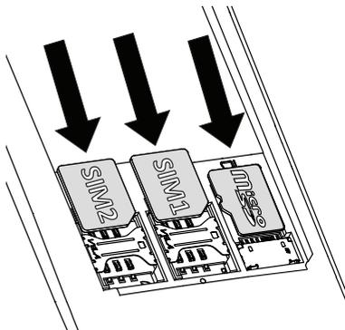
Tenga cuidado de no rayar ni doblar los contactos de la tarjeta SIM. Si tiene dificultades a la hora de retirar/sustituir la tarjeta SIM, utilice cinta adhesiva en la parte expuesta de la tarjeta SIM para extraerla.
