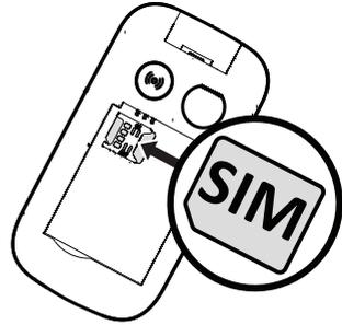
Cet appareil accepte les **cartes micro-SIM** ou **3FF**. L'utilisation de cartes SIM incompatibles peut endommager la carte ou l'appareil et éventuellement altérer les données stockées sur la carte.
