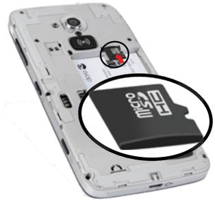
**Tipp:** Die Kontakte der Speicherkarte oder SIM-Karte dürfen beim Einlegen in die Kartenhalterungen nicht zerkratzt oder verbogen werden.
