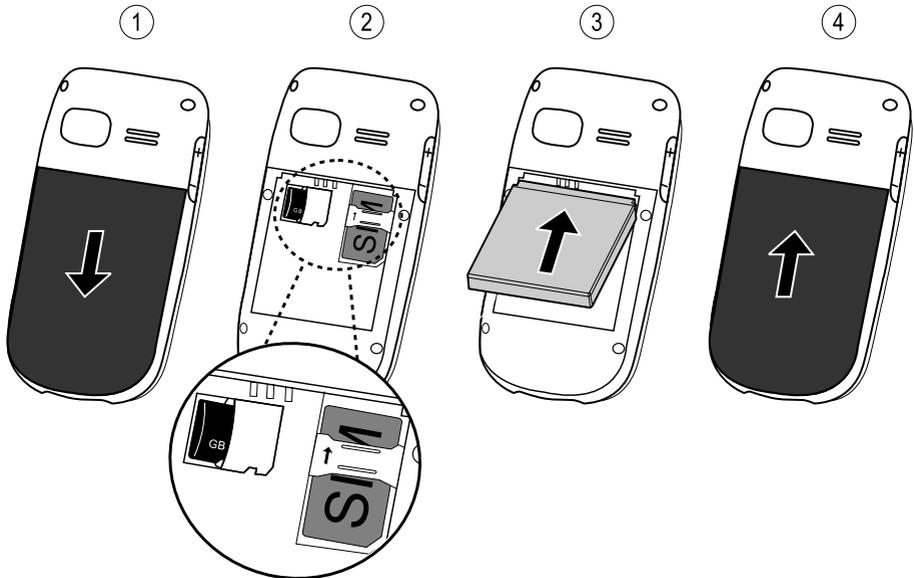
1. Entfernen Sie die Abdeckung des Akkufaches und den Akku, sofern dieser bereits eingelegt ist.
