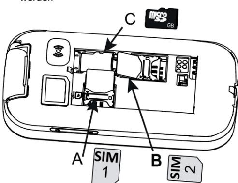
**Hinweis!** Achten Sie darauf, dass die Kontakte der Karte nach unten zeigen und die abgeschrägte Kante wie abgebildet positioniert ist. Die Kontakte der Karten dürfen nicht zerkratzt oder verbogen werden. Das Gerät akzeptiert Micro-SIM-Karten (3FF) und microSD-Karten.
