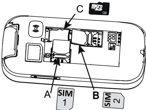
**Nota!** Controllare che i contatti della scheda SIM siano rivolti verso il basso e che l'angolo smussato della stessa sia orientato come in figura. Fare attenzione a non graffiare o piegare i contatti presenti sulle schede. Questo dispositivo accetta micro-SIM (3FF) e microSD.
