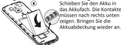
Schieben Sie den Akku in das Akkufach. Die Kontakte müssen nach rechts unten zeigen. Bringen Sie die Akkubehälterabdeckung wieder an.
