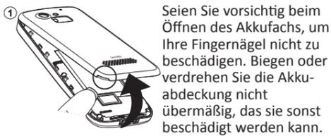
Seien Sie vorsichtig beim Öffnen des Akkufachs, um Ihre Fingernägel nicht zu beschädigen. Biegen oder verdrehen Sie die Akkubehälterabdeckung nicht übermäßig, da sie sonst beschädigt werden kann.
