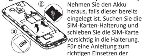
Nehmen Sie den Akku heraus, falls dieser bereits eingelegt ist. Suchen Sie die SIM-Karten-Halterung und schieben Sie die SIM-Karte vorsichtig in die Halterung. Für eine Anleitung zum richtigen Einsetzen der SIM-Karte siehe die Anleitung neben der Halterung. Das Gerät akzeptiert Micro-SIM- oder 3FF-SIM-Karten. Wenn Sie Probleme beim Entfernen/Einlegen der SIM-Karte haben, kleben Sie ein Stück Klebeband auf den freiliegenden Teil der Karte und ziehen Sie sie damit heraus.
