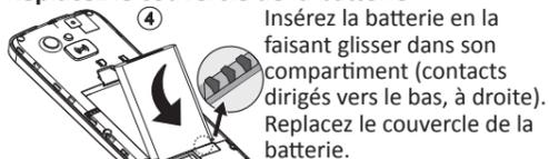
Insérez la batterie en la faisant glisser dans son compartiment (contacts dirigés vers le bas, à droite). Remplacez le couvercle de la batterie.
