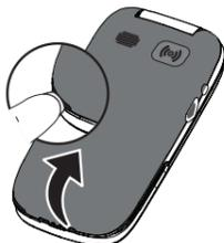
Attention à ne pas vous abîmer les ongles lorsque vous retirez le couvercle de la batterie. Attention à ne pas tordre ou déformer le couvercle de la batterie, au risque de l'abîmer.
