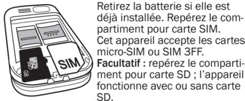
Retirez la batterie si elle est déjà installée. Repérez le compartiment pour carte SIM. Cet appareil accepte les cartes micro-SIM ou SIM 3FF. **Facultatif :** repérez le compartiment pour carte SD ; l'appareil fonctionne avec ou sans carte SD.
