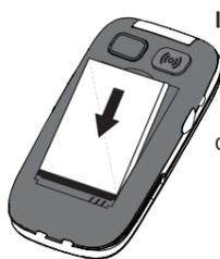
**Insérez la batterie.** Insérez la batterie en la faisant glisser dans son compartiment (contacts en bas, à droite). Remplacez le couvercle de la batterie.
