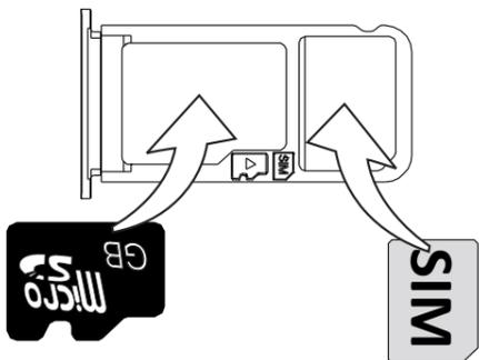
Achten Sie darauf, dass die Kontakte der SIM-Karte nach unten zeigen und dass die abgeschrägte Kante nach unten zeigt (siehe Abbildung). Die Kontakte der SIM-Karte dürfen nicht zerkratzt oder verbogen werden.
