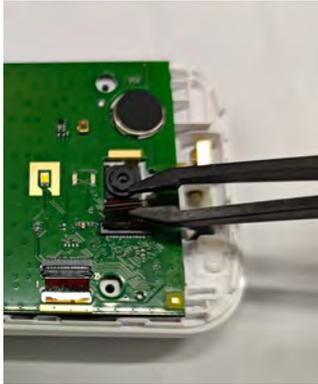
3. Lift the **Camera** using **Tweezers**.
